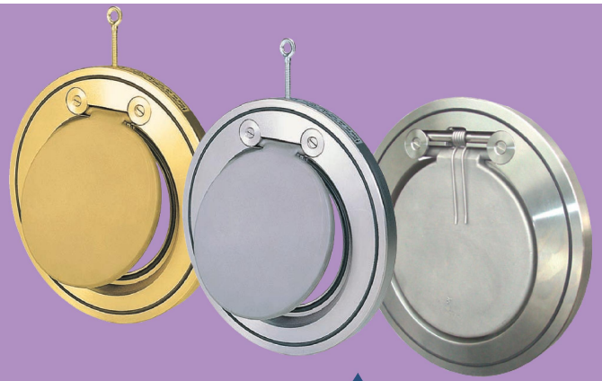
Valvole di ritegno a clapet serie GS dimensioni da 2" a 24" PN 6 + 25 / ANSI 150 - ANSI 300 acciaio - acciaio inox acciai speciali (Duplex® - Superduplex® - Hastelloy®)
